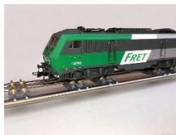
Ha adquirido un banco de pruebas M2R y espero que esté plenamente satisfecho con él. Es especialmente adecuado para probar locomotoras, configurar equipos analógicos y digitales, pero también para fines de demostración.
