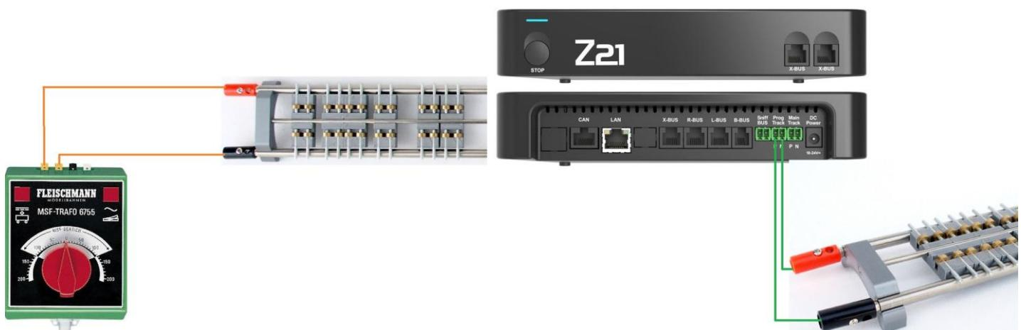
\_Anschluss des Prüfstands für 3-Leiter-System (Märklin):
