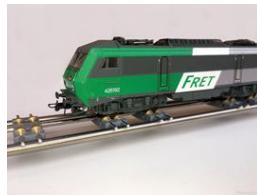
Sie haben einen M2R-Prüfstand gekauft und ich hoffe, Sie sind damit zufrieden. Es eignet sich besonders zum Testen von Lokomotiven, zum Einstellen von analogen und digitalen Geräten, aber auch zur Demonstration.
